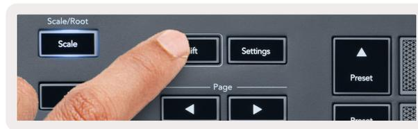
FL Studio で Channel Rack が表示されている状態で、任意のパッドレイアウトモード時に Shift ボタンを長押しすると、現在の選択項目が表示されます。チャンネルバンク、Channel Rack で選択中のノブやチャンネルが確認できます。Mixer Volume/Pan モード時は、選択中のミキサーバンクが表示されます。
