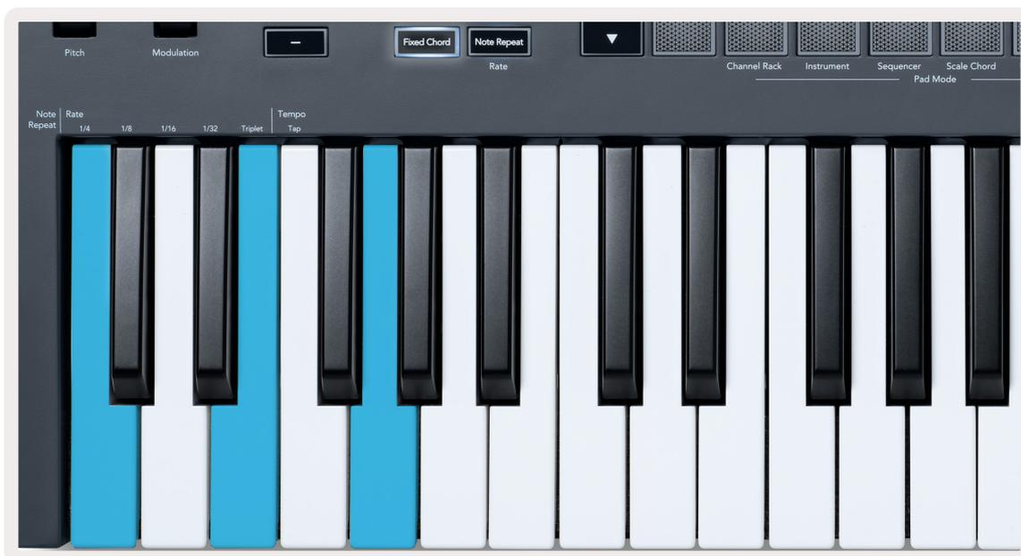
たとえば、Fixed Chord ボタンを押しながら C、E、G の順に鍵盤を押し手を離します（Cメジャーコード）。FLkeyはこのコードを Fixed Chord（固定コード）として記録します。Fixed Chord ボタンから手を離すと設定が完了します。
